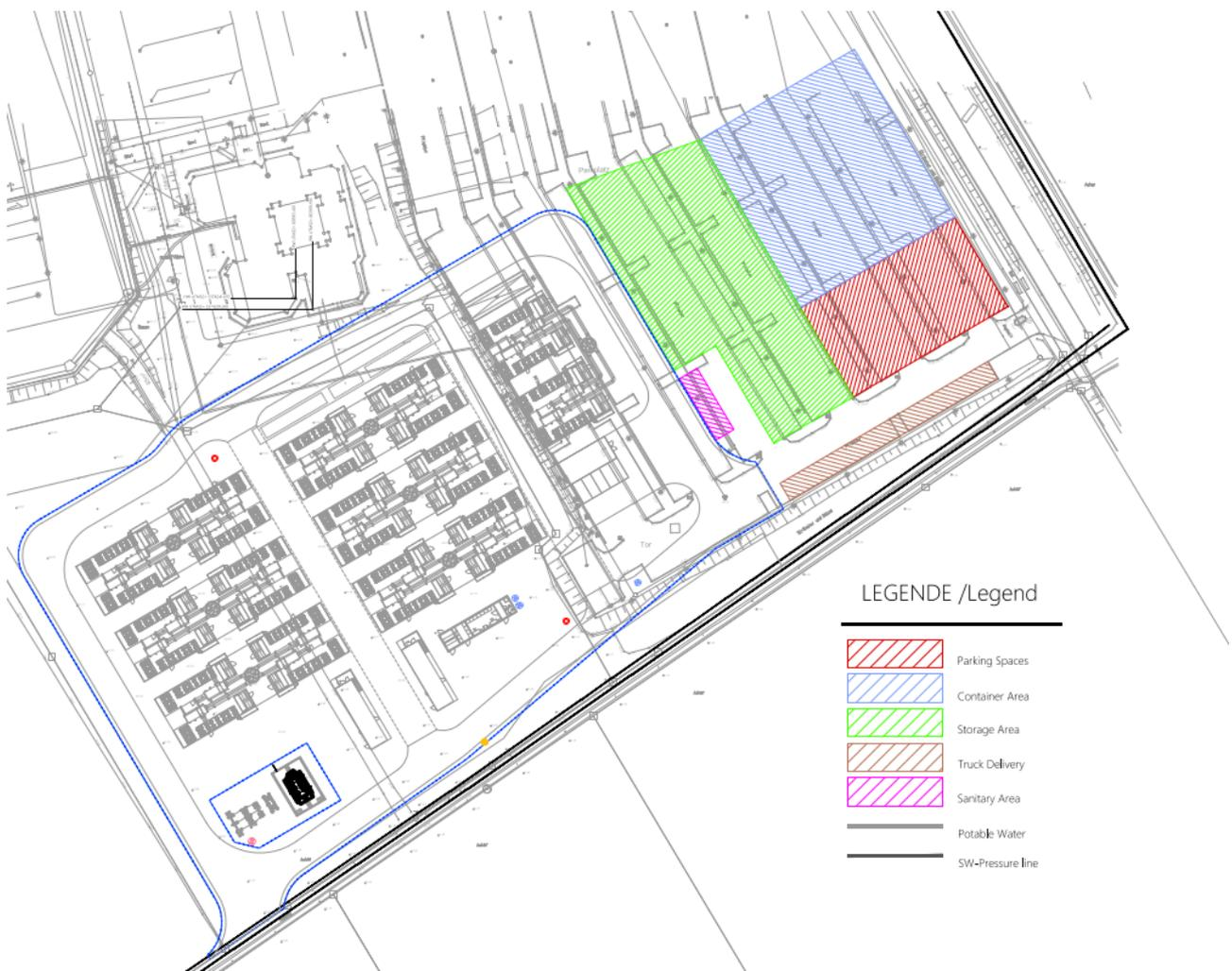
Abb. 1: Anordnung der geplanten Peakeranlage inkl. Baustelleneinrichtungsflächen, o.M.
