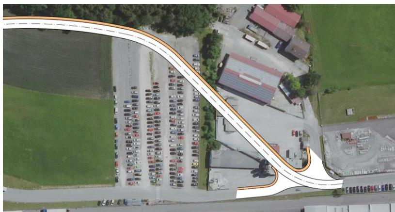
Abbildung 6: Untervariante bei Stat. ca. 0+420 - 0+700 über das Gelände des bestehenden Betonwerks
