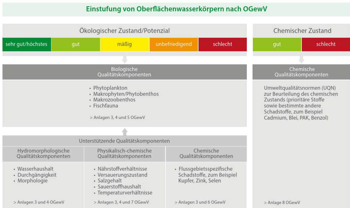
Abbildung 1: Einstufung von Oberflächenwasserkörpern der Kategorie Flüsse nach der Oberflächengewässerverordnung; Hanusch M. und Sybertz J. (2018)
