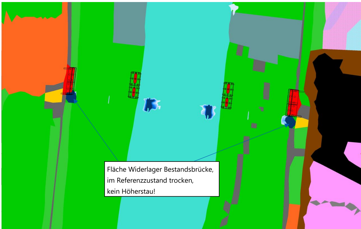
Abbildung 10: Endzustand, HQ100, Differenz WSP Endzustand minus Referenzzustand, Farbabstufung 1 cm, nur Höherstau dargestellt
