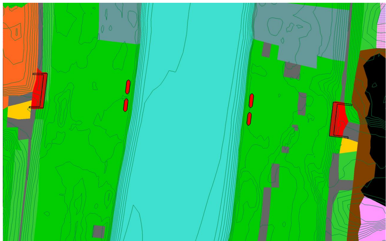
Abbildung 7: Bauzustand 1, oben Lageplan und Schnitt, unten 2D-HN-Modell mit Landnutzungsdaten und Höhenlinien Gelände
