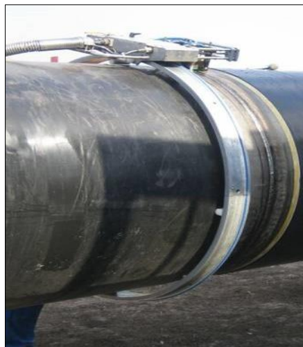
Abbildung 18: Prüfen der Schweißnähte mittels Ultraschall- / Durchstrahlungsprüfung
